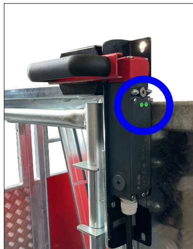
foto 2 (Luce verde: ha incontrato il pattino di fermata al piano e si può aprire)
